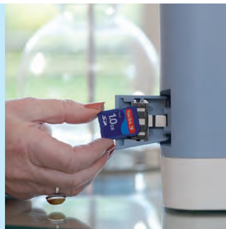
SD-Karte mit 1 GB Speicherplatz zum Speichern der Beatmungsdaten von bis zu einem Jahr.
